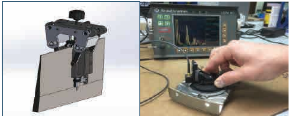
高精密机械结构是保证检测可靠性及重复性的关键
